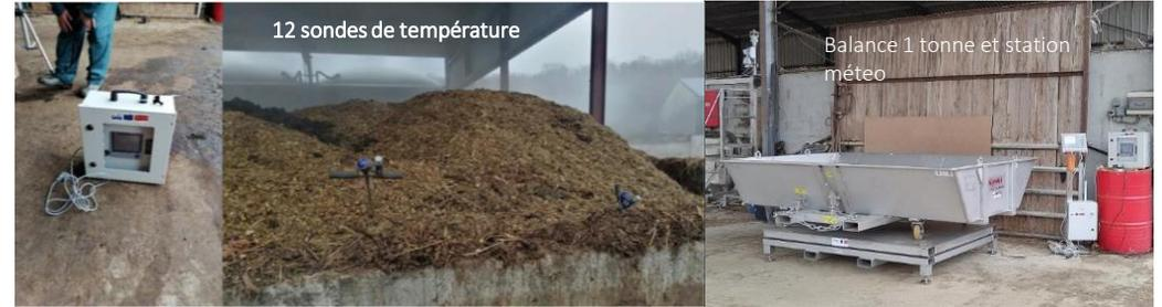
Suivi de la température et de la perte de masse des substrats grâce à des dispositifs adaptés et prélèvements des substrats.
