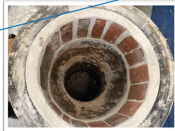
Briques réfractaires tapissant l'intérieur du foyer
