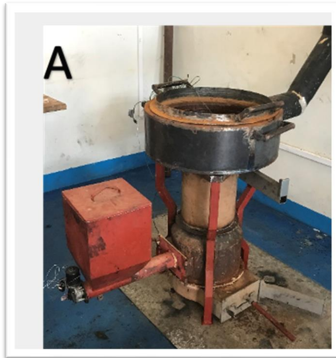
Foyer en argile - Structure acier
